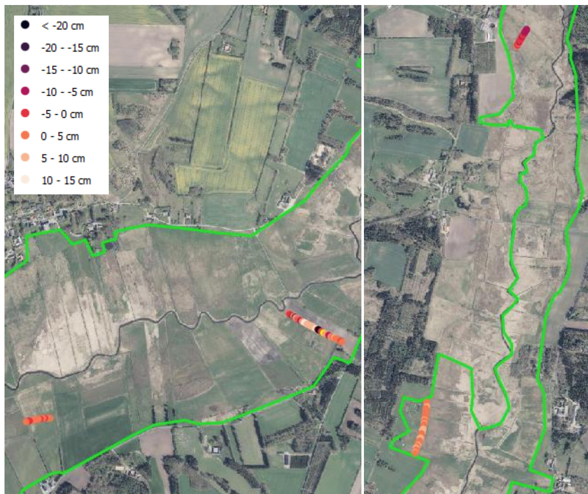
Figur 3-5 - Forskel mellem opmålte punkter og højdemodellen (opmålt kote minus DHM). Undersøgelsesområdet er klippet, så det er nemmere at se målepunkterne. (Ortofoto Kilde: KDS CC-BY4)
