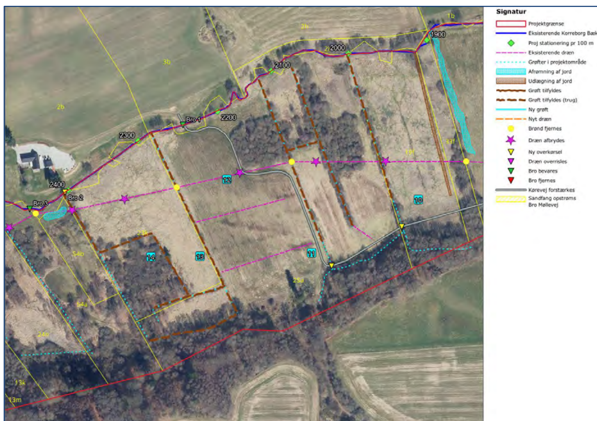
Figur 29 Oversigtskort af vandings- og afvandingsystem 10-14 (se også Bilag 5.2)
