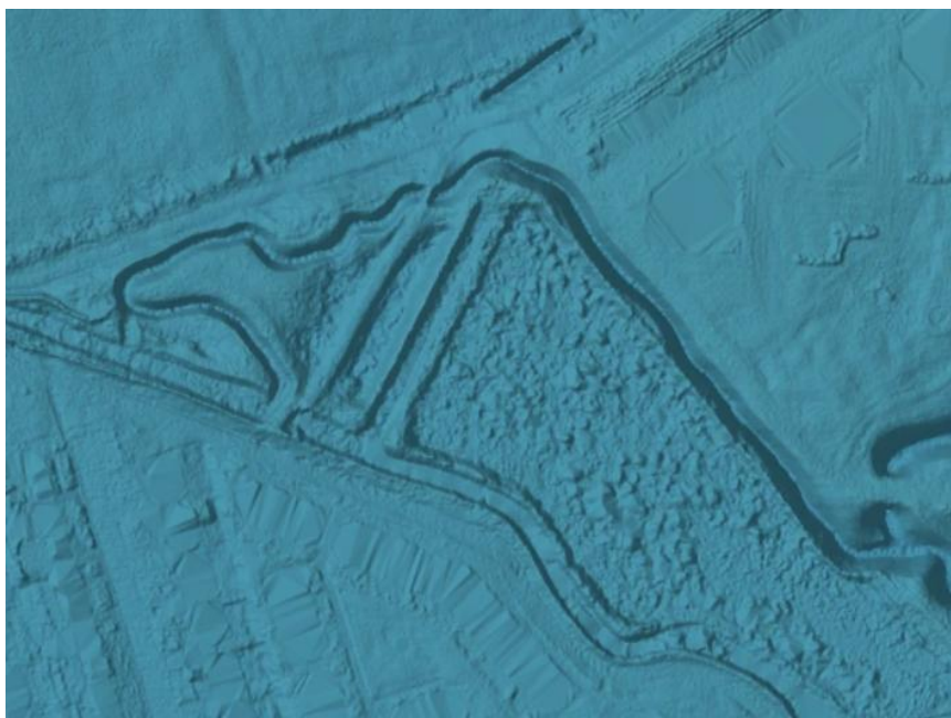
Figur 6 Terrænprofil viser at vandløbet ligger lavt i terræn.
