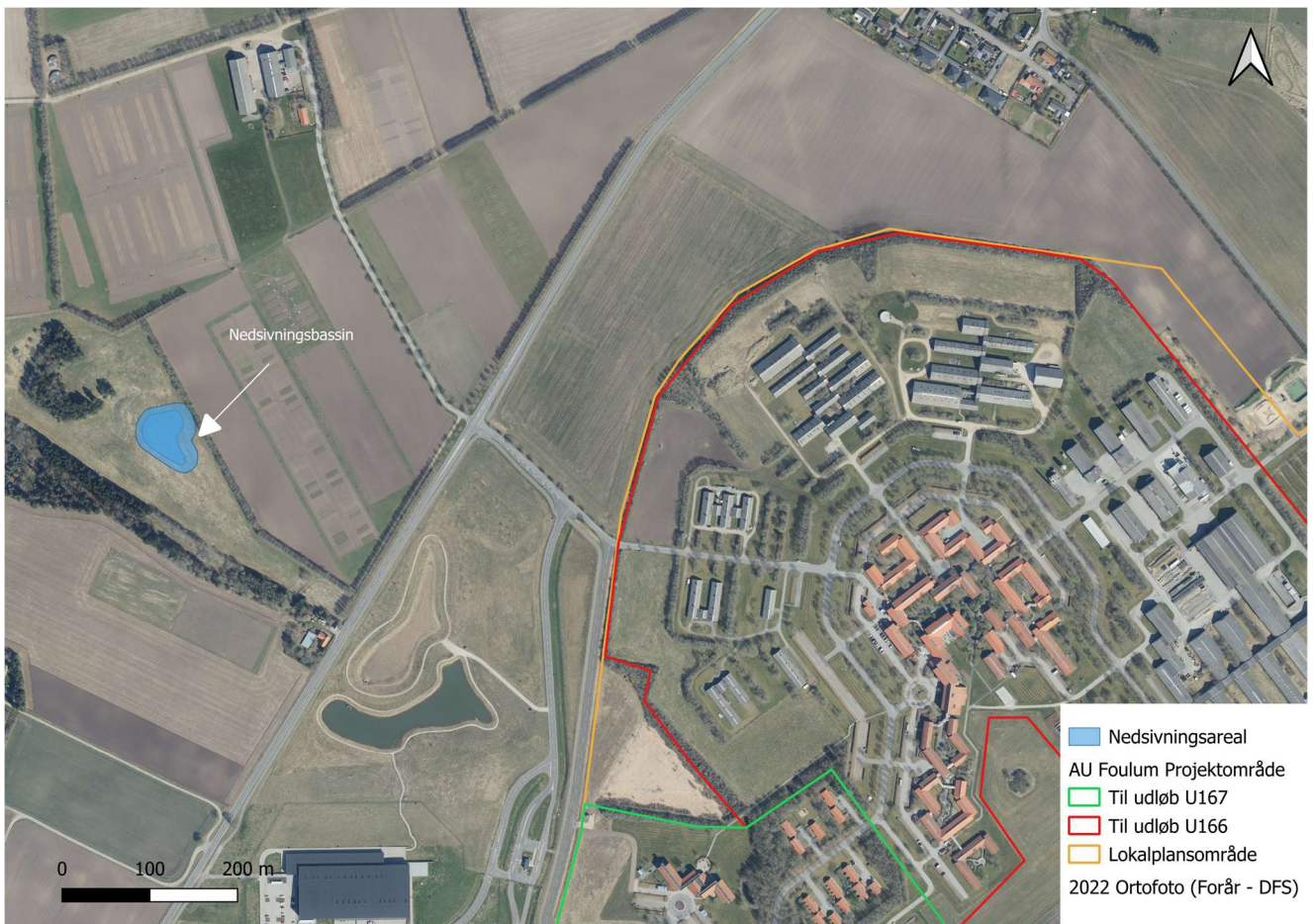
Figur 3.13: Placering af skitseret nedsivningsbassin.
