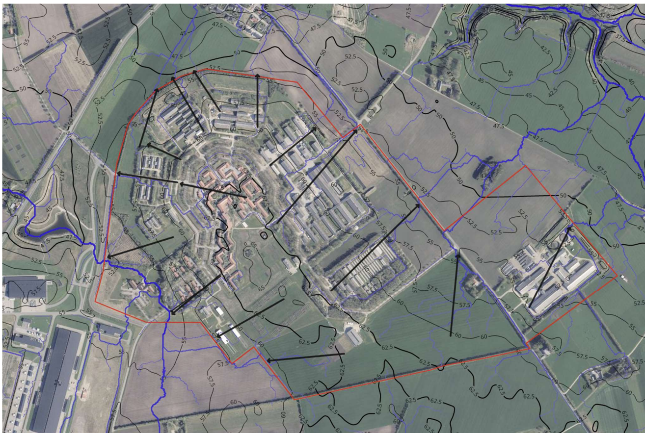
Figur 2.5: Oversigtskort over strømningsveje pba. højdemodellen fra Scalgo. Den røde afgrænsning angiver lokalplanområdet. De sorte pile viser terrænhældningerne inden for området. Højdekurver er markeret med sorte linjer.
