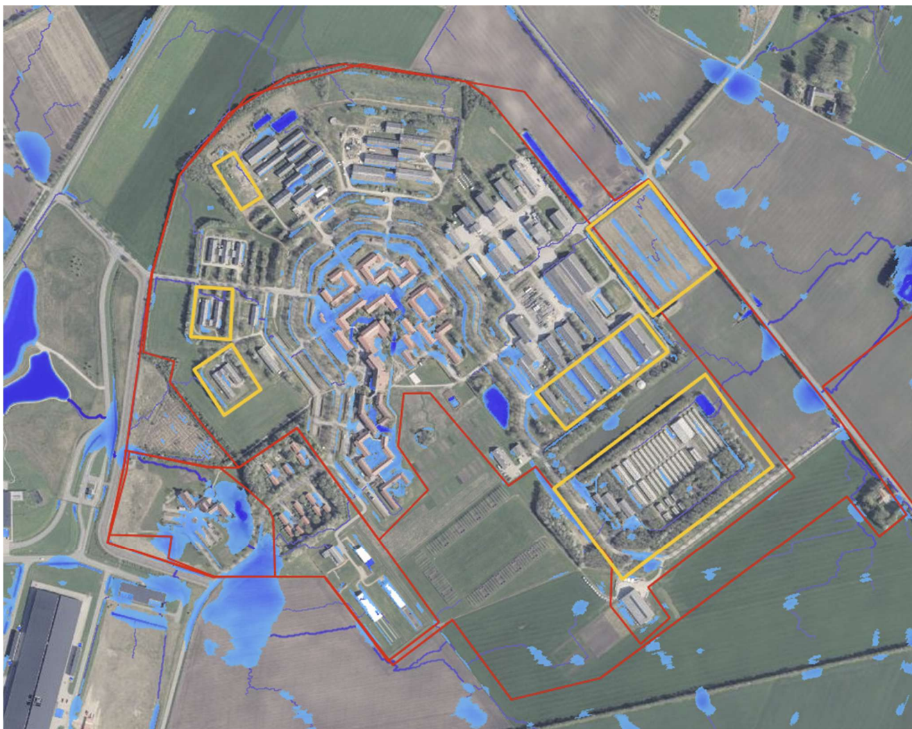
Figur 4.3: Oversigtskort over strømningsveje pba. højdemodellen fra Scalgo ved oplande over 1 ha. skybrudslavn timer er ved 53 mm. Den røde afgrænsning angiver AU Viborgs arealer. Terrænet er ved fremtidige forhold, hvor eksisterende bygninger er fjernet hvor dette er planen. Markering af arealer hvor der sker ændringer i områder er markeret med gul.
