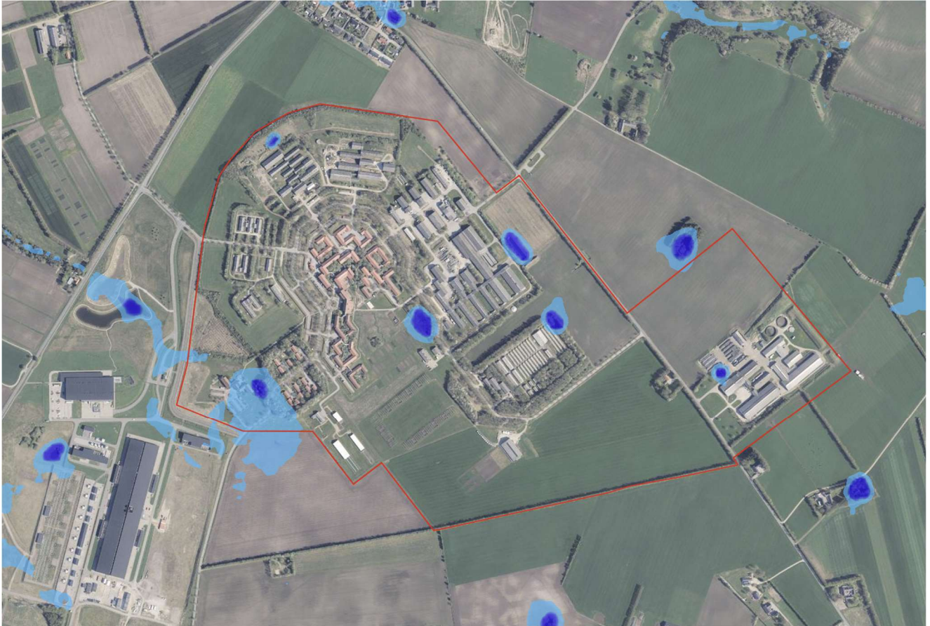
Figur 2.3: Beliggenhed af terrænnært grundvand (vinter). De blå farver viser en grundvandsstand på 3,0 MUT eller derover. Der vises mest sandsynlige vintergrundvandsstand. Modelberegnet i "DK-Model HIP" for perioden 1990-2020, kilde: Scalgo. Vandløb er beskrevet på tegningen.
