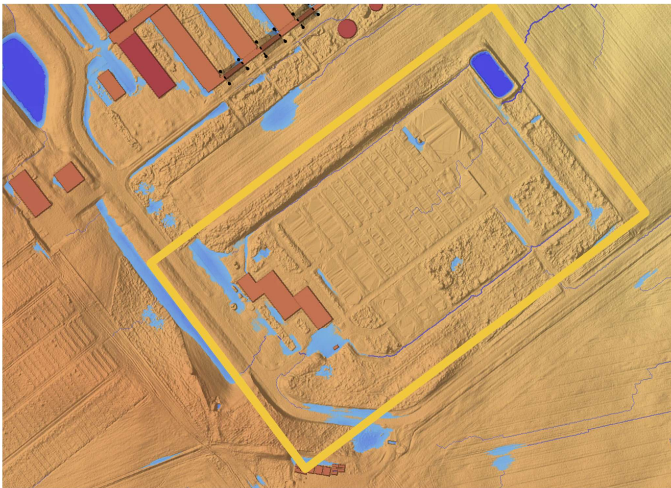
Figur 4.4: Oversigtskort over strømningsveje pba. højdemodellen fra Scalgo ved oplande over 100 m 2 . Skybrudslavninger er kortlagt ved 53 mm. Den gule afgrænsning angiver arealer, hvor der fjernes skybrudslavninger ved fjernelse af bygninger. Terrænet er ved fremtidige forhold, hvor eksisterende bygninger er fjernet.
