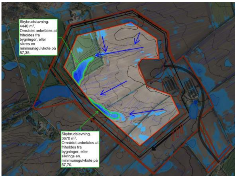
Figur 15-5. Viser forslag til fremtidig skybrudshåndtering inden for perimetermuren.
