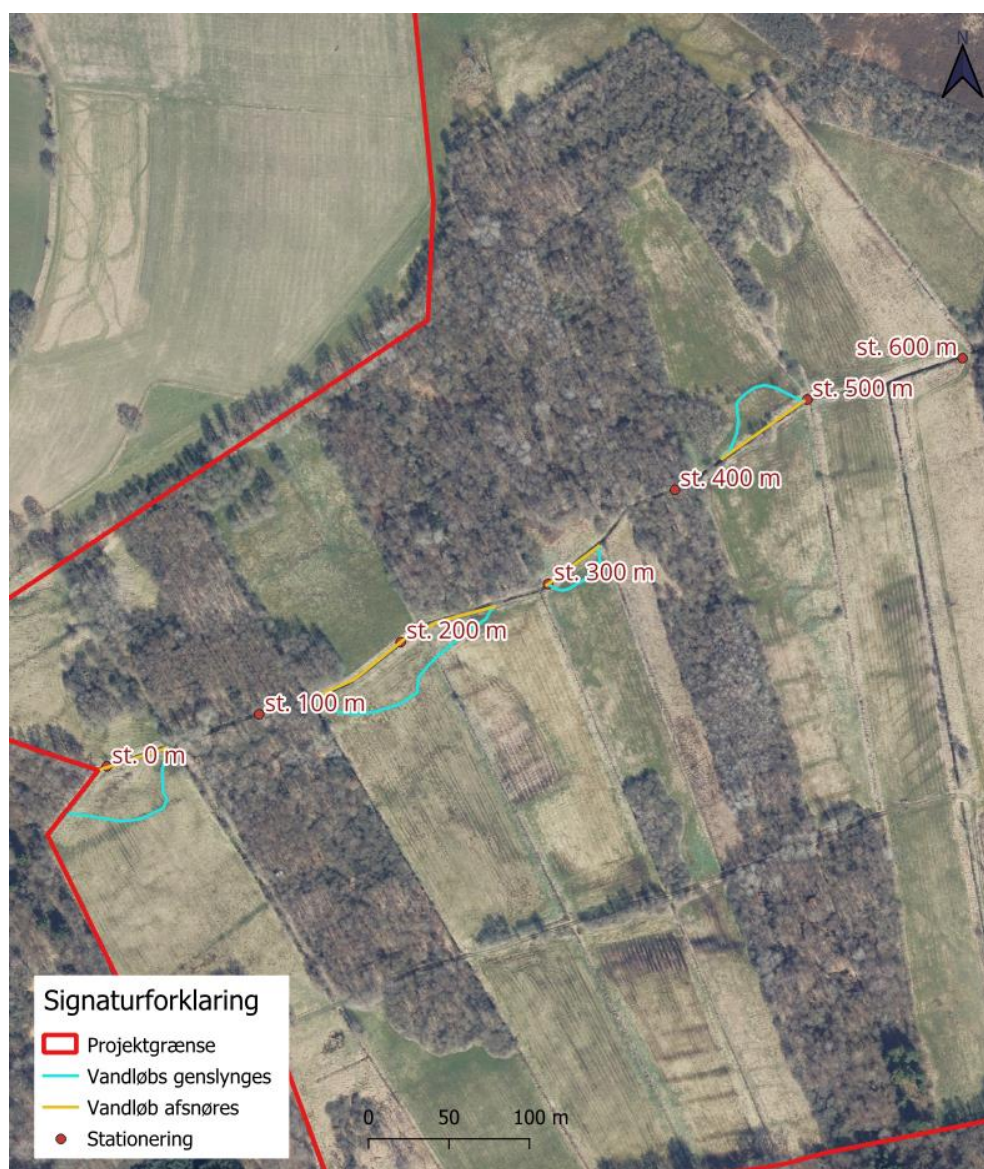
Figur 5-5 Forslag til genslyngning af Skovkærbækken. Lys blå farve er forslaget til genslyngningen. Gul farve indikerer, hvor nuværende forløb opfyldes.
