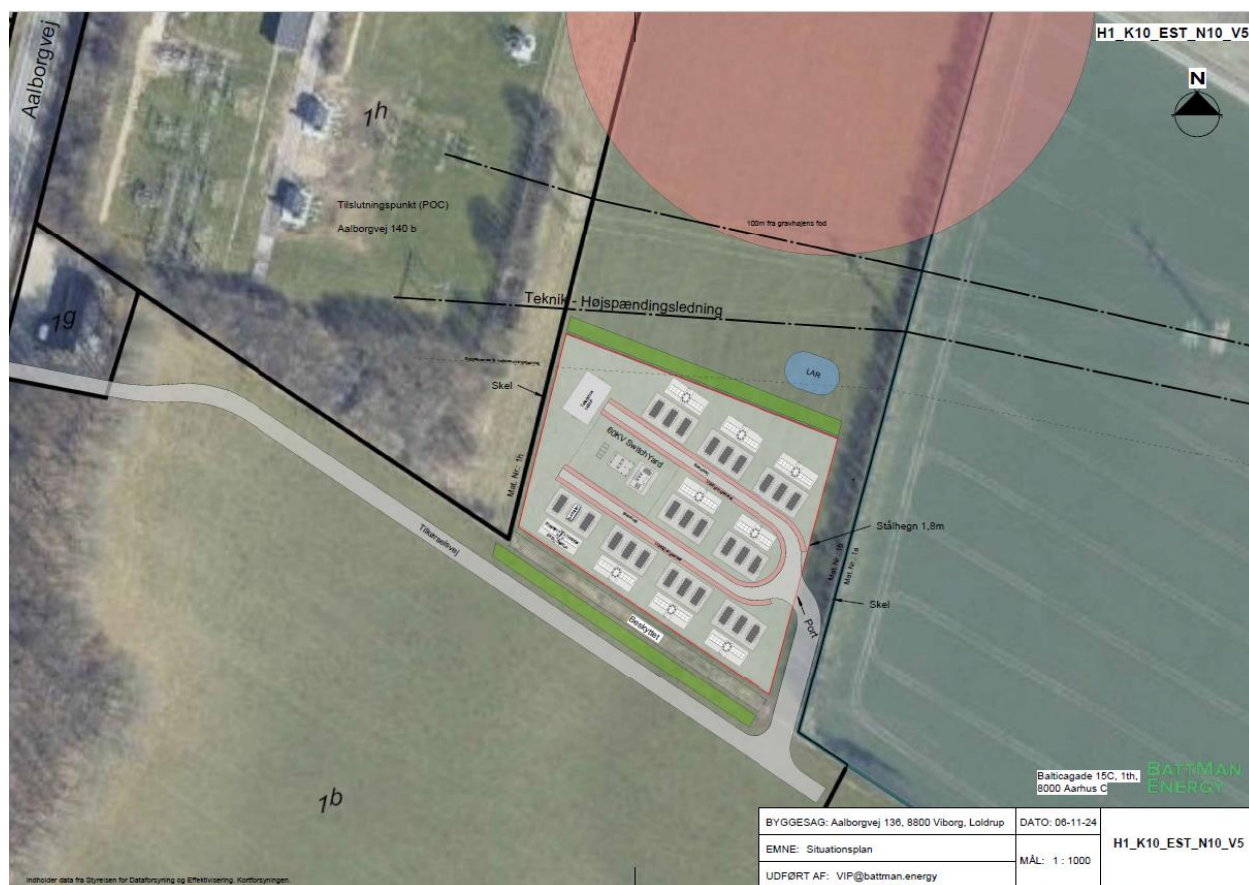
Figur 1: Areal og situationsplan for batterianlægget.
