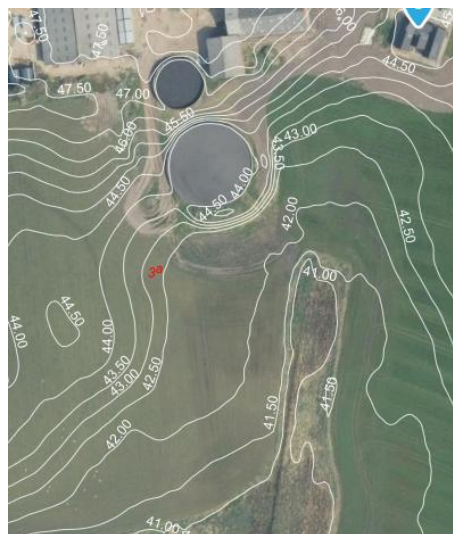
Figur 5 Terrænet falder let mod vandløb/grøft
