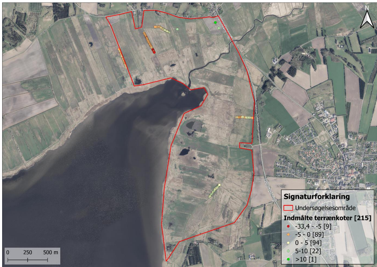
Figur 3-6 Forskel mellem højdemodellen og indmålte terrænpunkter. Kilde, højdemodel: Scalgo Live. Ortofoto (2025) hentet via Danmarks Miljøportal.
