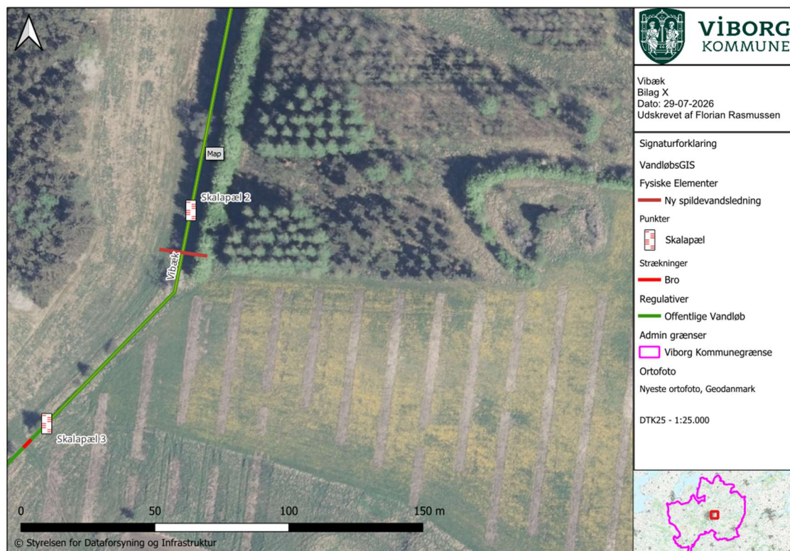
Figur 2: Placering af krydsning af Vibæk med spildevandsledning.
