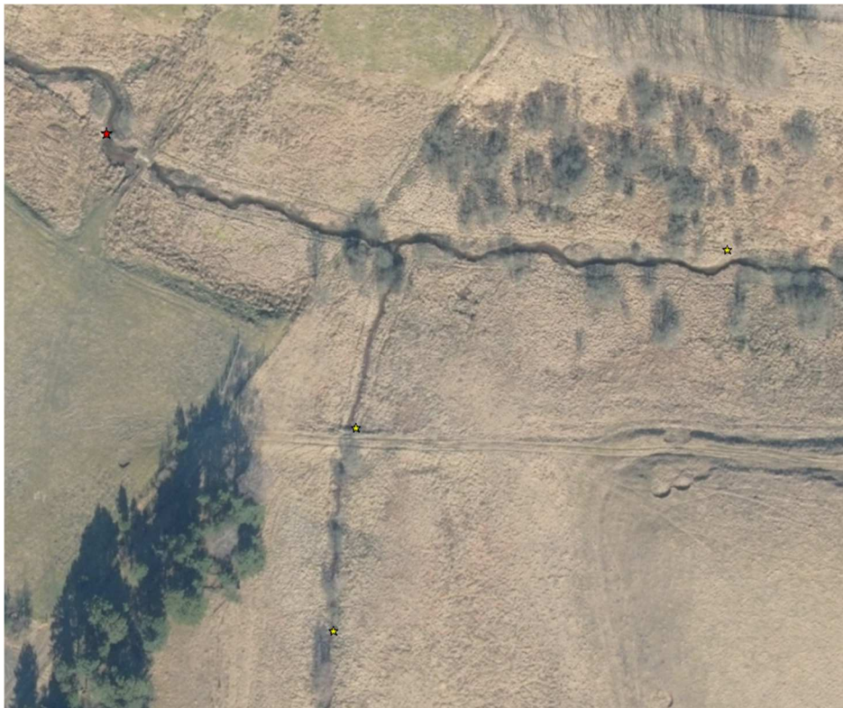
Figur 6: Rød stjerne er sandfanget. Gul stjerne er gydebanke. Gydebanke nr. 5 (Resen Bæk mod øst) tilgås fra sydsiden ved brug af køreplader og gravmaskine. Gydebankerne 17 og 18 i Østerhede Bæk tilgås fra vestsiden af vandløbet med køreplader og gravemaskine.
