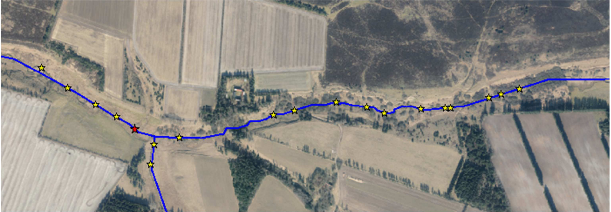
Figur 1: Samlet projektoversigt – gydebanks markeret med gule stjerner, mens sandfanget er vist med en rødstjerne.
