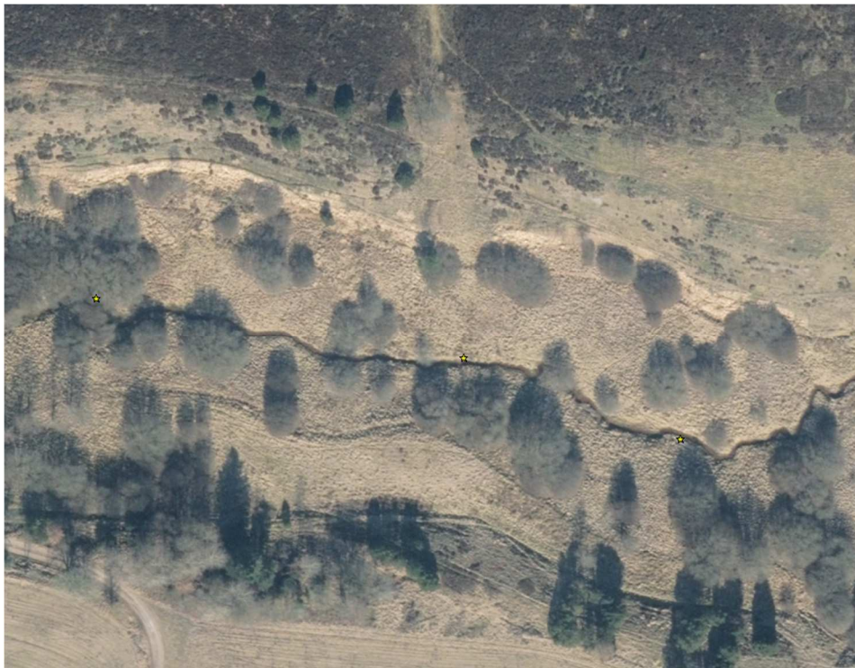
Figur 4: Gul stjerne er gydebanke. Gydebankerne 8-10 tilgås fra sydsiden af Resen Bæk. Her anvendes køreplader og motorbør. Ved nogle af gydebankerne er der en brat kant ned mod bækken hvor der ikke kan køres. Her anvendes en køreplade til at glide gruset ned i bækken. Det kan komme på tale at beskære nogle af piletræerne i forbindelse med transport af materiale til Resen bæk. Dette gøres de steder, hvor det vurderes at være mere skånsomt for de naturtyper og arter der er i området.
