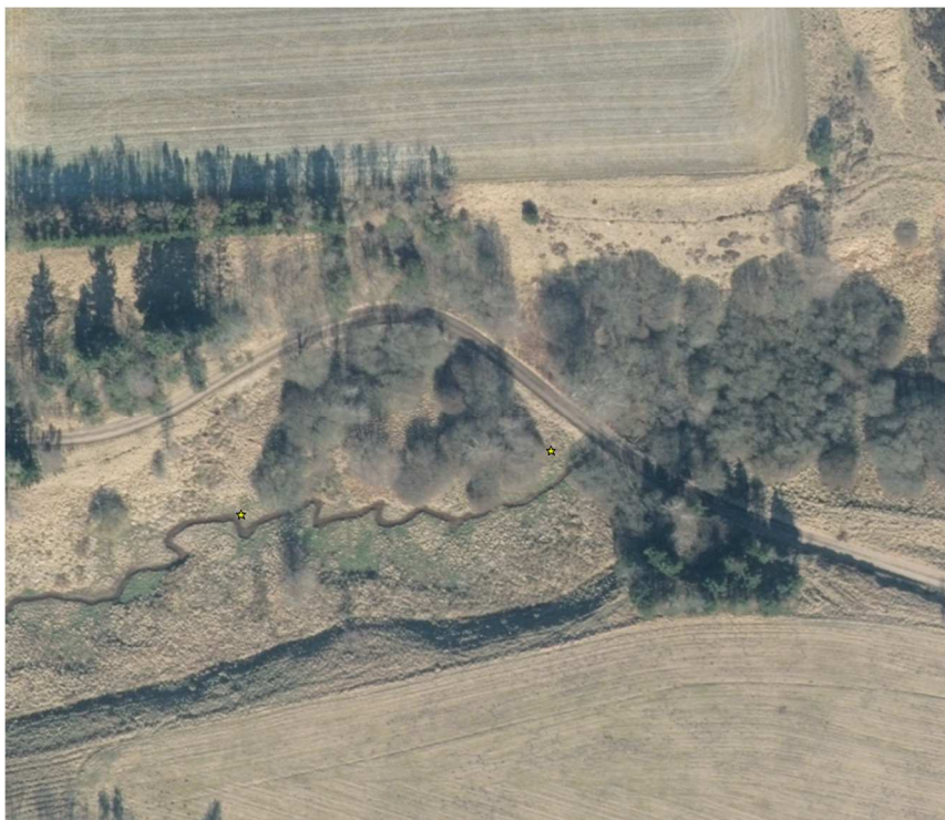
Figur 5: Gul stjerne er gydebanke. Gydebanke nr. 6 (vest) tilgås fra nordsiden af Resen Bæk. Der anvendes motorbør og køreplader. Der køres uden køreplader til kanten af ådalen hvorefter der skal anvendes køreplader. Gydebanke nr. 7 (øst) anlægges med motorbør og uden køreplader.
