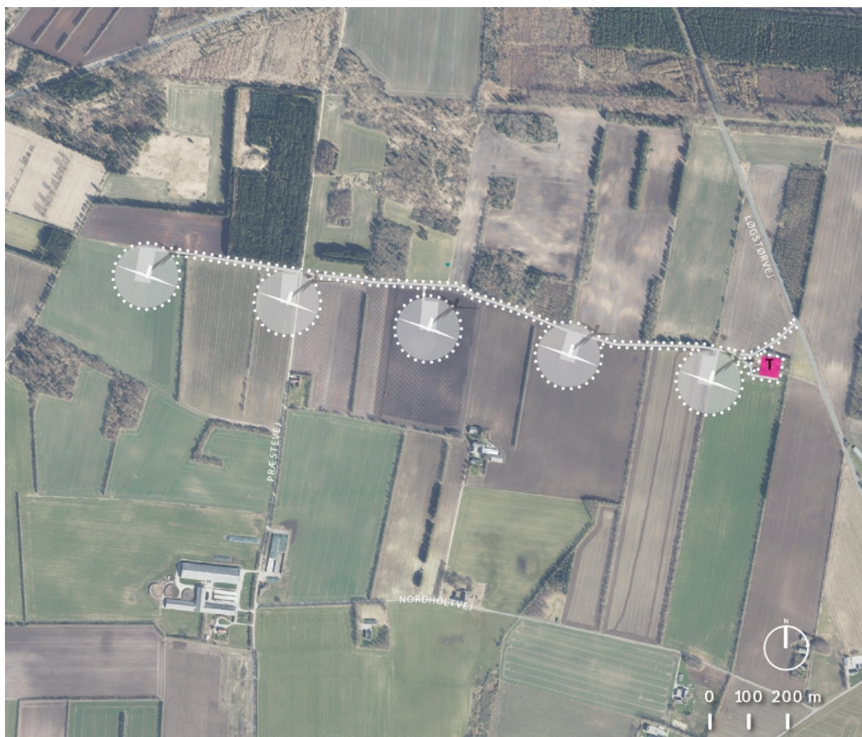
Figur 1. Afgrænsning af lokalplan og kommuneplantillæg, adgangsveje og møllernes placering og nummer. Pink flade viser hvor stepup- transformeren kan placeres inden for plan- og projektområdet.
