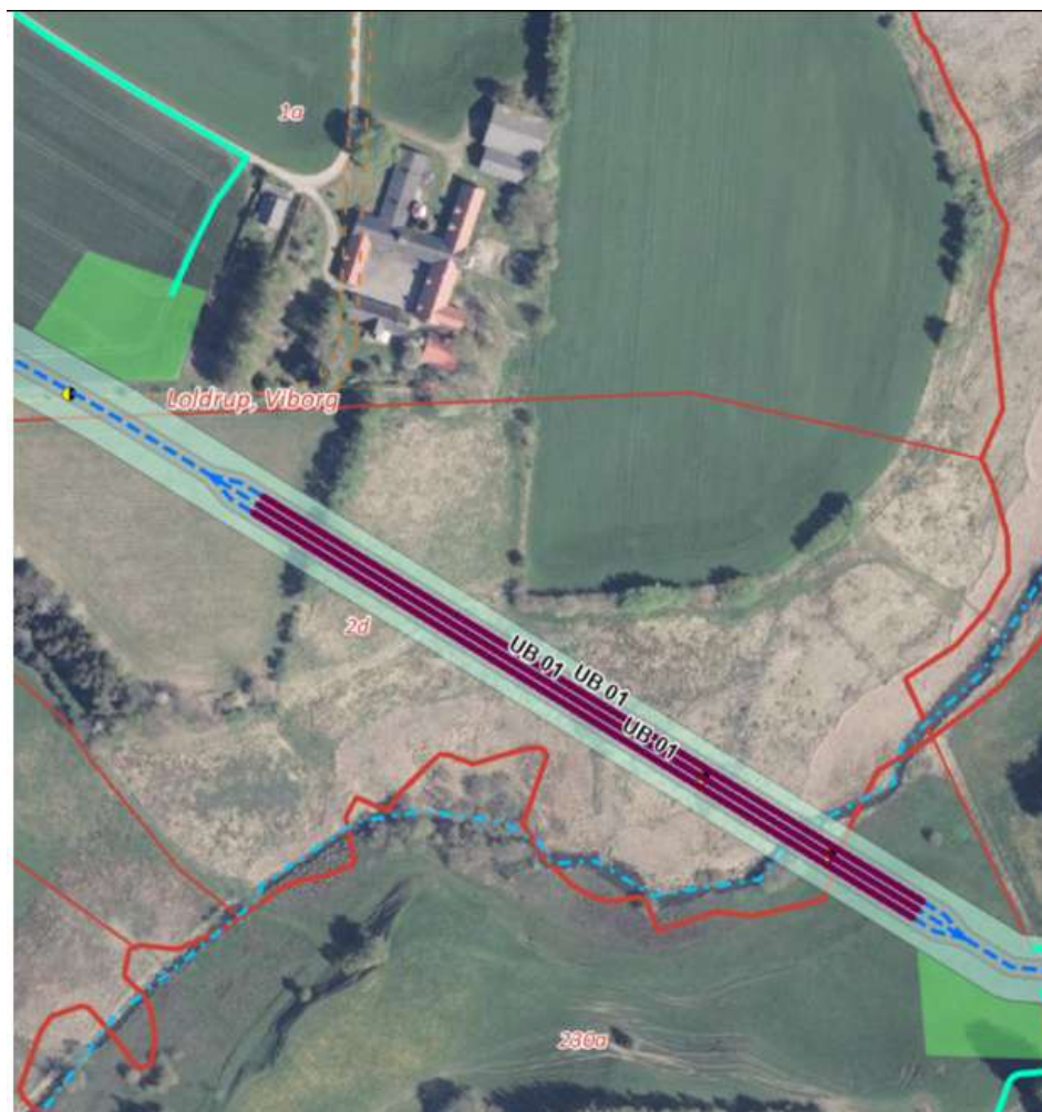
Figur 3. Udklip fra ansøgning. Rød streg markerer tracé for styret underboring under Nørremølle Å.
