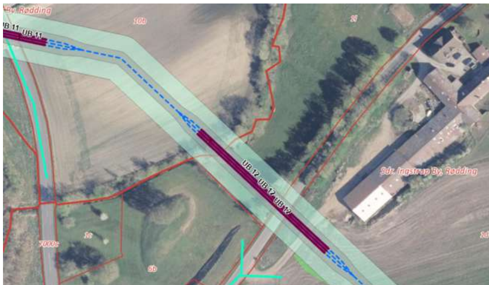
Figur 2. Udklip fra ansøgning. Rød streg angiver tracé for styret underboring af Tjele Å.
