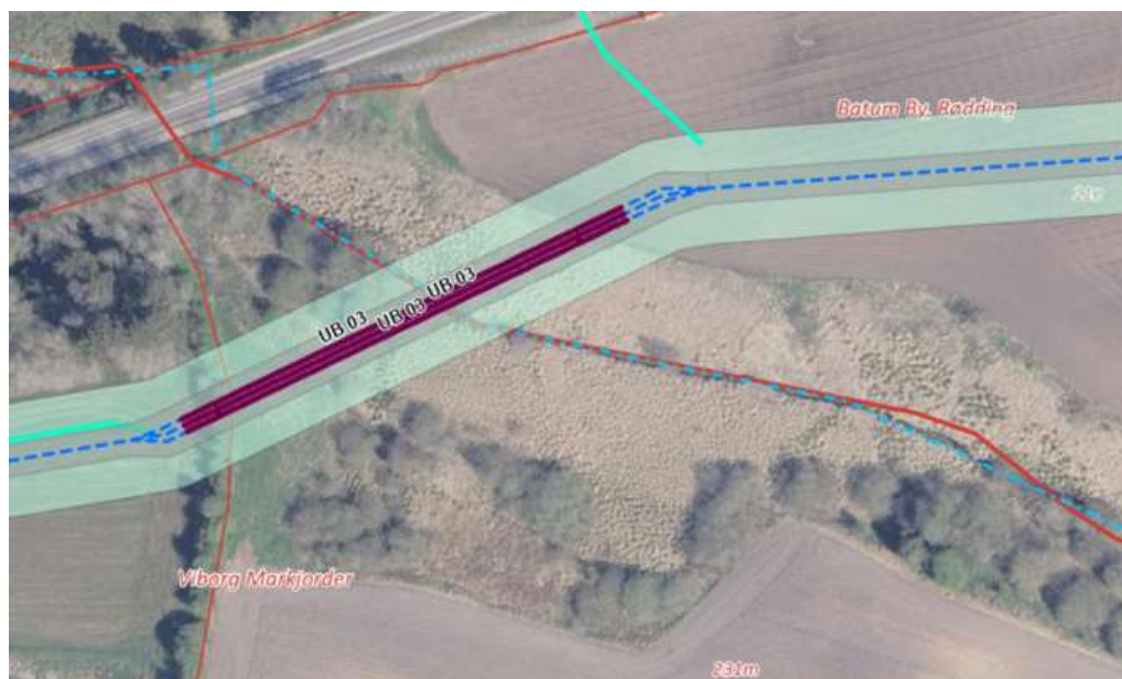
Figur 4. Udklip fra ansøgning. Rød streg markerer tracé for styret underboring af Stigsbæk.
