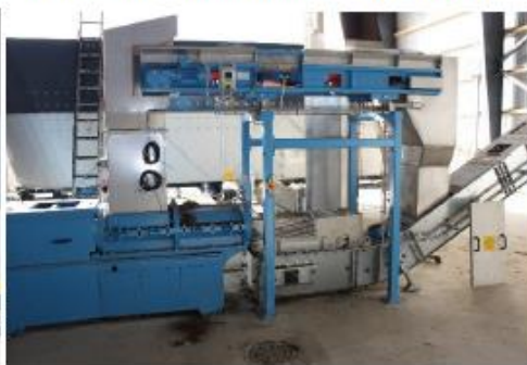
Extruder og start på indfødning med redler
